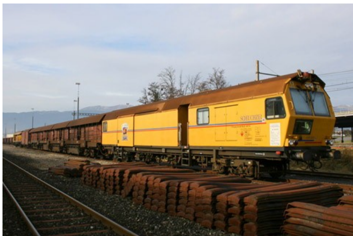
Train meuleur de rails (Scheuchzer S.A.)
